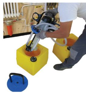
TANK 22 Codice 300610007 dove poter preparare la soluzione acida pronta all'uso. Questo permette di avere la pompa sempre a disposizione per la soluzione neutralizzante, quindi massima sicurezza e protezione della pompa e dell'impianto da disincrostare. Grazie alla possibilità di svitare e avvitare in 10" e senza attrezzatura tutta la pompa, Manta è l'unica azienda produttrice che permette di arrivare sul posto di lavoro con la soluzione acida e neutralizzante pronte ad un rapido uso.
