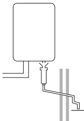
4. Completare l'installazione del tubo della condensa in base alle normative vigenti.
