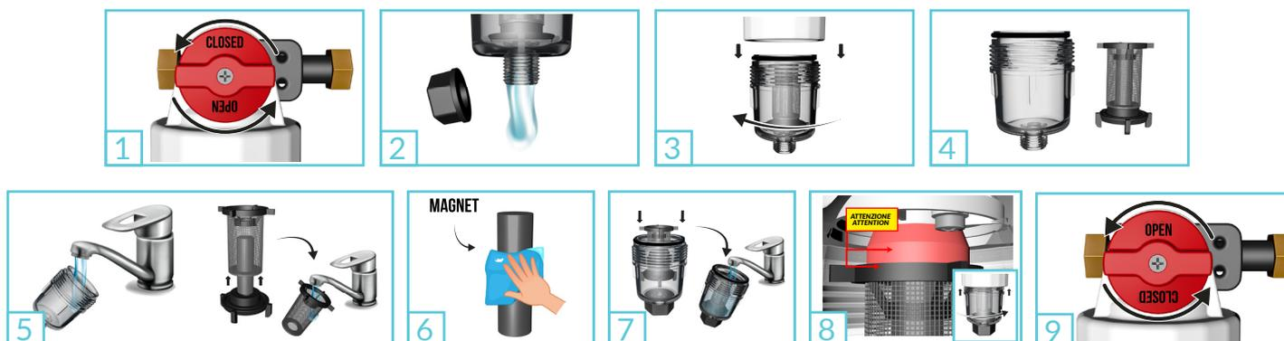
Ad ogni smontaggio mantenere gli O-Ring LUBRIFICATI con grasso silconico.
